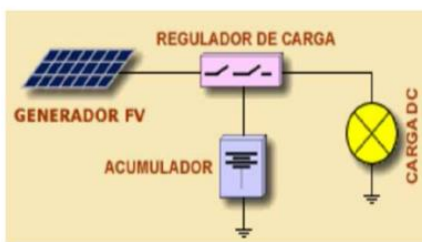
Sistema Fotovoltaico Aislado (SFA)
