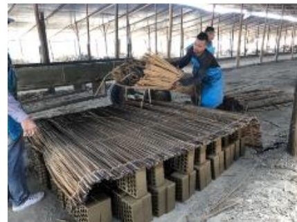
Ilustración 36: Fase de retiro de ladrillo secado.
