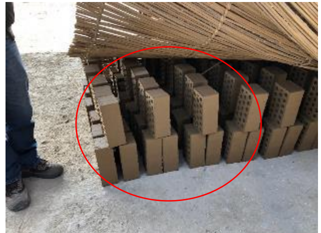
Ilustración 11: Apilamiento de ladrillo Tipo II crudo KingKong en 2 filas para pruebas.
