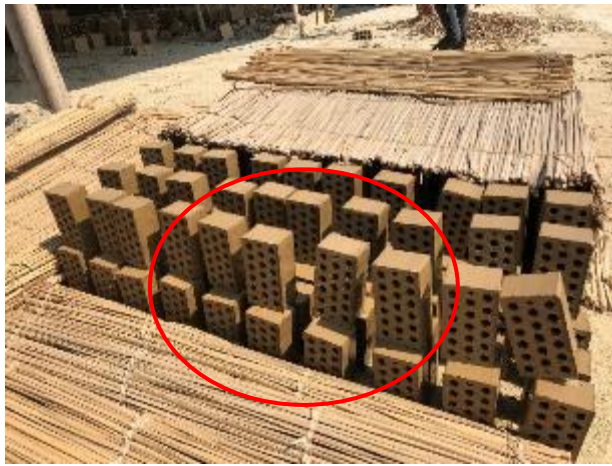
Ilustración 10: Apilamiento de ladrillo Tipo II, crudo KingKong, en 2 filas para pruebas.
