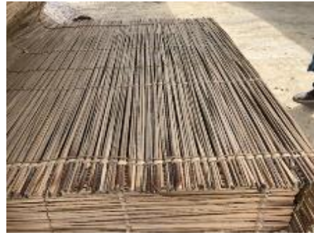
Ilustración 34: Proceso cobertura de secado de ladrillo
