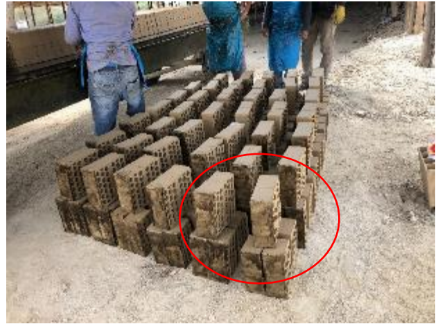
Ilustración 9: Apilamiento de ladrillo Tipo I KingKong, en 2 filas.
