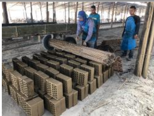
Ilustración 37: Ladrillo listo para ser retirado.
