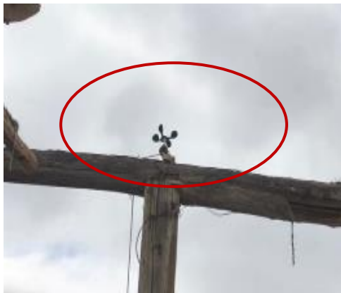
Ilustración 17: Prototipo inicial de medición de velocidad de viento y temperatura.
