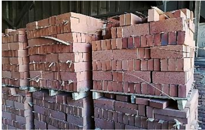
Ilustración 2 Ladrillo KingKong 18 huecos maquinado.
