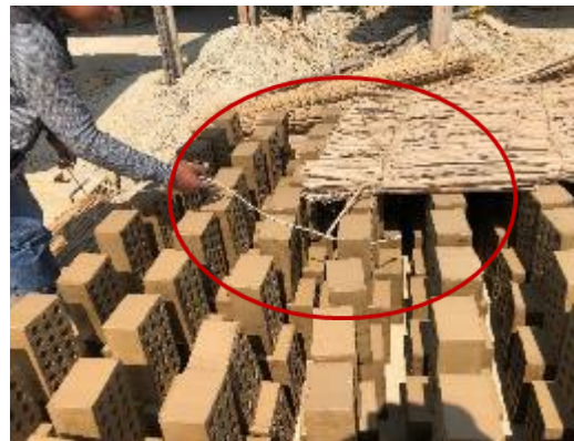
Ilustración 22: Sensor de medición de temperatura del ladrillo en el proceso de secado.
