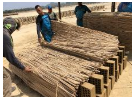
Ilustración 32: Cobertura para sombra en proceso de secado de ladrillo.
