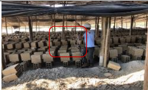
Ilustración 29: Monitoreo de secado de ladrillo bajo Malla.
