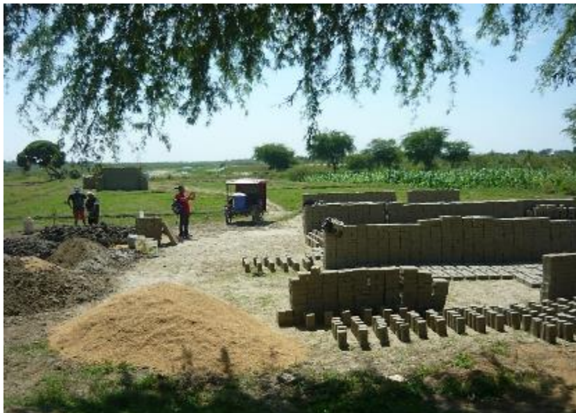
Ilustración 4 Proceso de secado de ladrillo artesanal en pampa.
