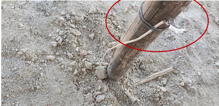
Ilustración 12: Sensor de almacenamiento de temperatura y humedad, en pampa..
