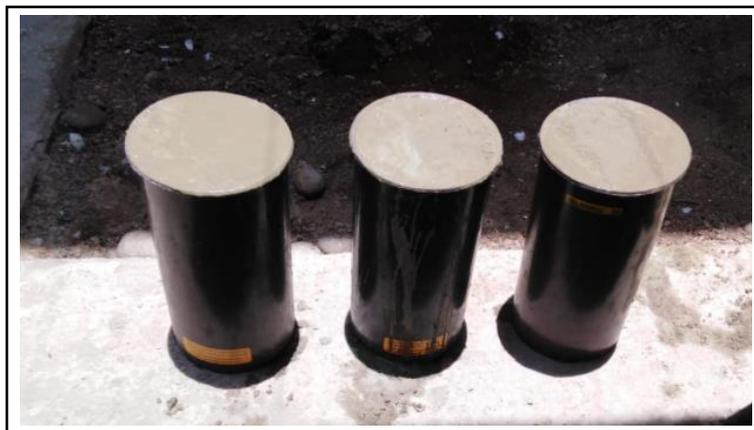
**Figura 2.** Probetas de concreto.
