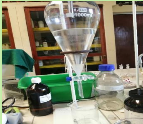
Decantación de fase acuosa residual formada en muestra de fase orgánica
