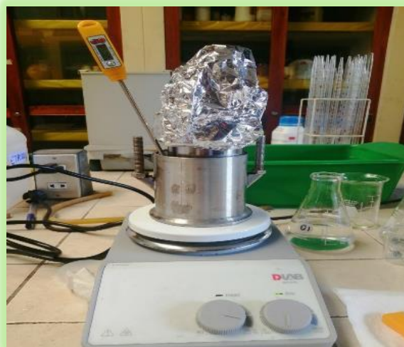
Reactor envuelto en papel filtro para concentrar el calor
