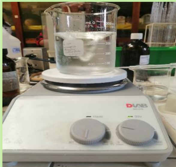
Mezcla de sulfito de sodio anhidro (agente químico deshidratante) en muestra de fase orgánica
