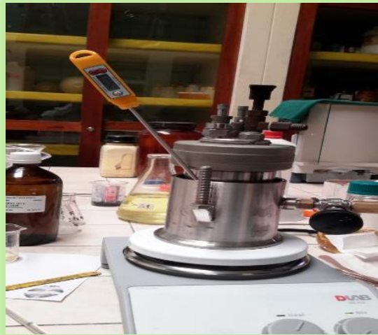
Bomba de vacío utilizada como reactor para deshidratación acida
