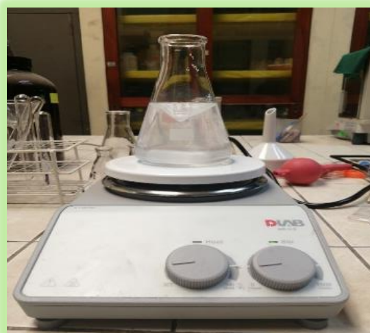
Mezcla de disolución de fructosa con HCl y NaCl para reacción de deshidratación ácida
