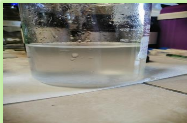
Formación de fase acuosa en el lado inferior de la muestra de fase orgánica
