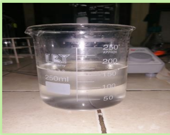
Vista de fase orgánica y fase acuosa en muestra después de haber sido sometida a deshidratación ácida
