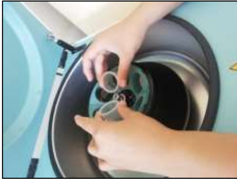
Figura 9: Suelo de 4g más 40ml de NaOH a centrifuga por 20 minutos y 5000rpm para fracción de HUM, AH y AF
