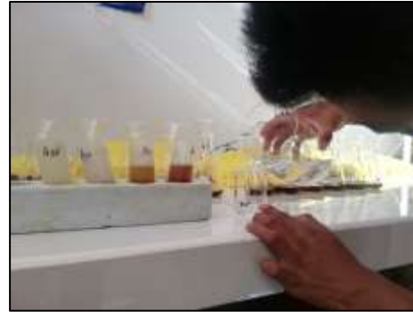
Figura 10: Adición de 15ml de NaOH para separación de fracciones de AF y AH. (Metodología de la Sociedad Internacional de Sustancias Húmicas).
