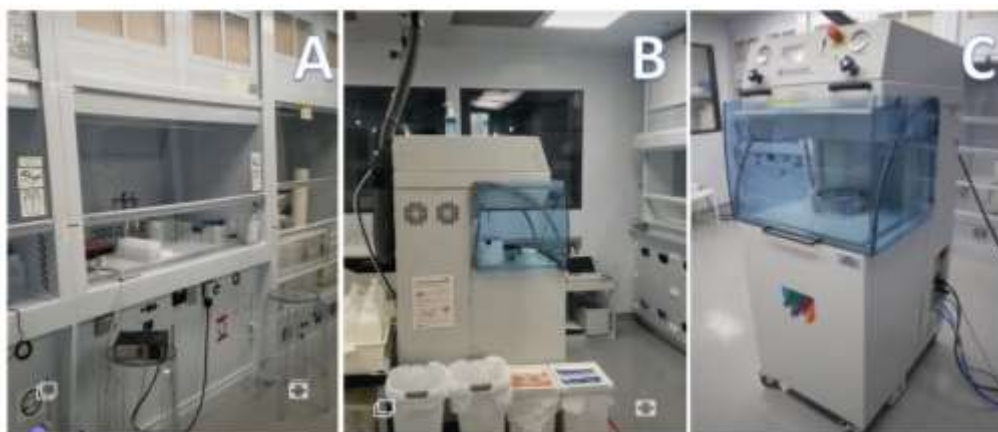
Anexo 15. Sala de preparación de muestras Clase 10,000, laboratorio SWAMP. A. Cabina de flujo laminar donde se pesaron las muestras y se agregó el HNO 3 . B y C. Ultraclave donde se realizaron las mineralizaciones.
