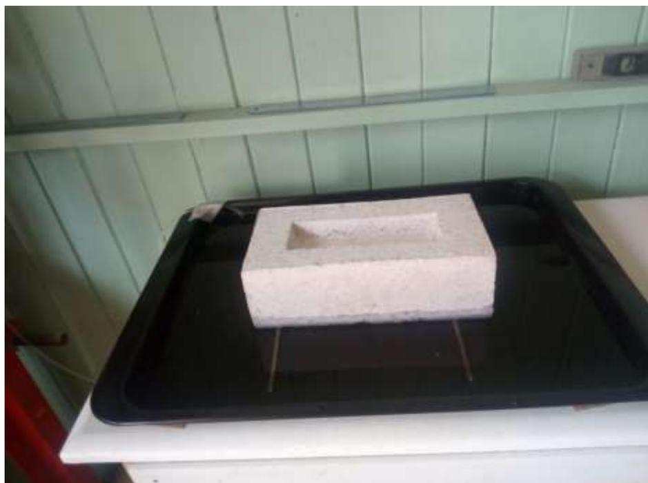
Figura 14. Medición de Absorción.
