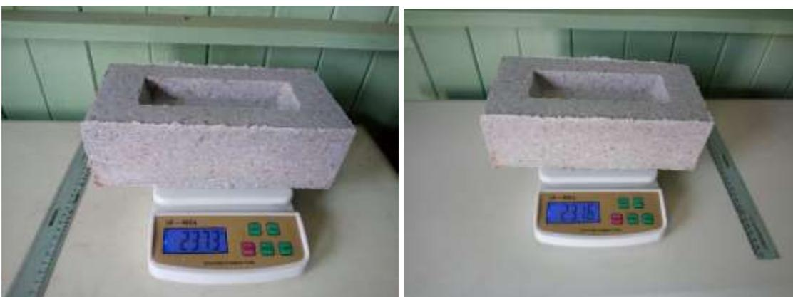
*Figura 10. Toma de medidas para determinar la variación dimensional.*
