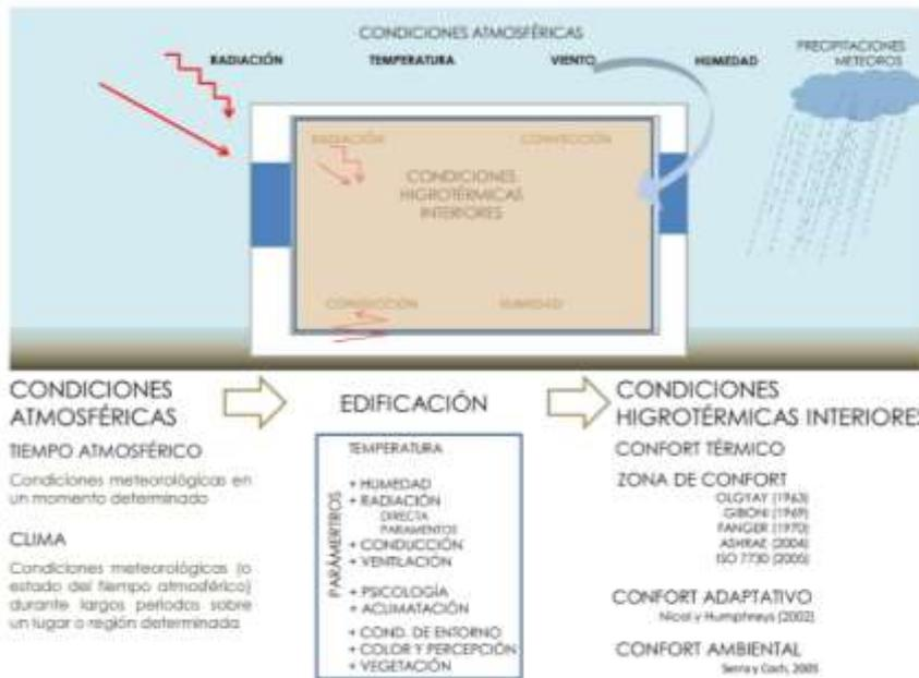
Fig. 19. Esquema de toma de decisiones para conseguir las condiciones de habitabilidad interior y los parámetros implicados en este proceso. Fuente: (Tendero, 2016)
