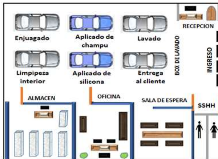
Figura 8. Layout de la empresa del servicio de autolavado. Fuente: Elaboración de los investigadores.
