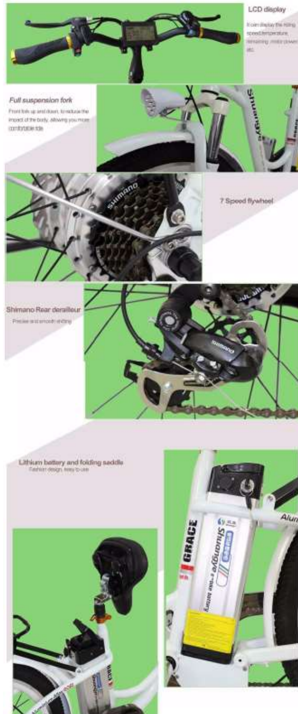
Ilustración 21. Características más relevantes de la bicicleta eléctrica.
