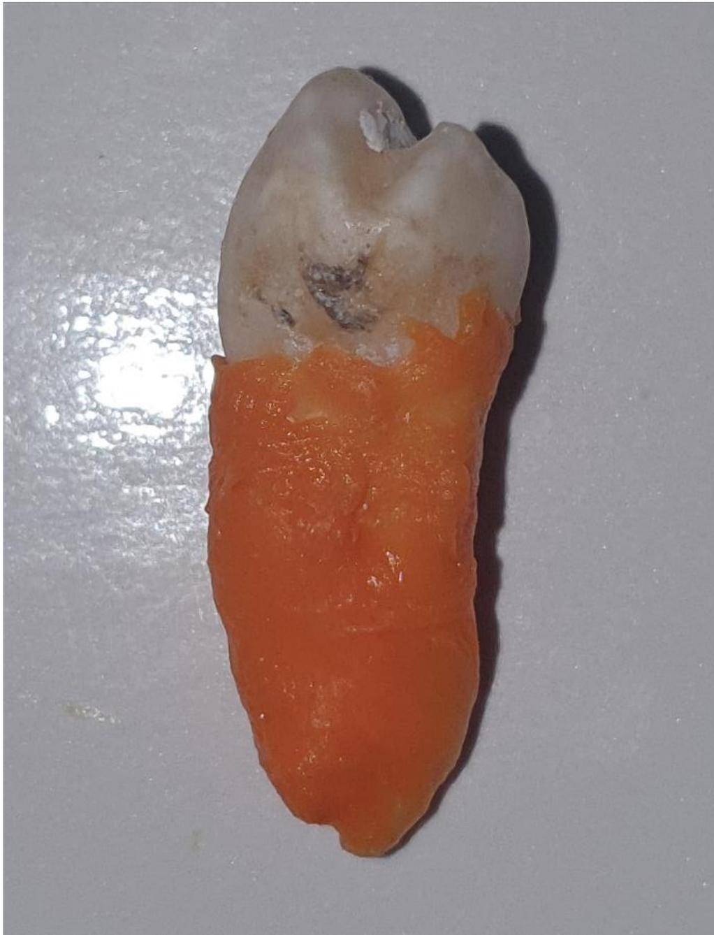
**Fotografía 13:** Elaboración del cilindro de acrílico para llevar el diente a la prueba de resistencia.
