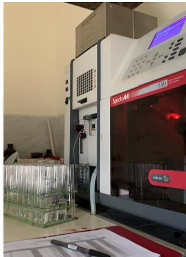
*Figura 15. Lectura de las muestras en el espectrofotómetro de absorción atómica*
