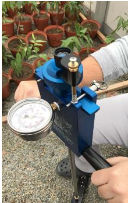
Figura 3: Cámara de presión utilizada para la medición del potencial hídrico de las hojas en el invernadero de la Universidad Científica del Sur
