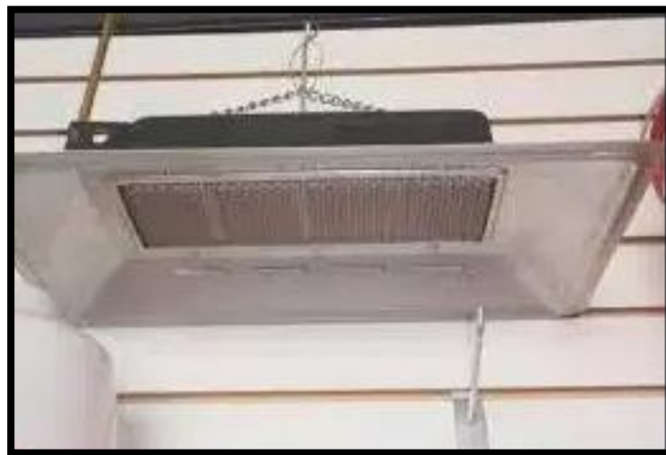
Figura 42 Campana de gas
