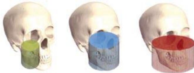
Esquema que muestra los diferentes tamaños de CAMPO DE VISIÓN de más pequeño (Izda.) a más grande (Dcha)
