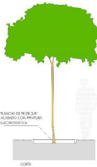
Figura 5.13 Plano detalle de Mobiliario Urbano: Alcorque. Elaboración propia
