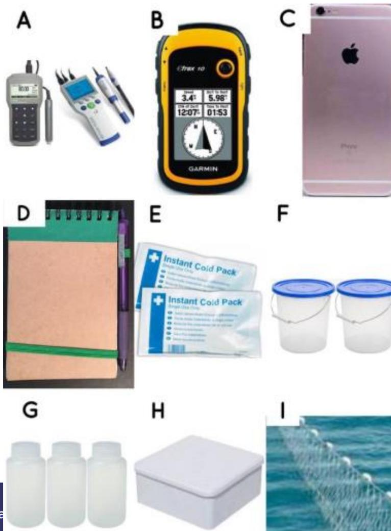
**Figura 5:** Instrumentos utilizados en el área de estudio. a) Conductímetro Hanna H198192 y multiparámetro Toledo con 2 sensores Sevensgo Duo pH/ion/Do (pH inlab expert Go-Ism, O<sub>2</sub> inlab optiox sensor, b) GPS Garmin etrex, c) Celular Iphone 6s (toma de fotos), d) Libreta de apuntes y lapicero, e) Paquetes de hielo, f) Baldes, g) Frascos estériles, h) Caja de tecnopor e i) Red de enmalle.
