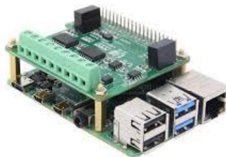
Figura 2 Microcontrolador Raspberry Pi 4 B y Tarjeta de Comunicación RS485
