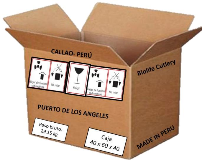
Para el marcado y etiquetado del envase secundario se emplea según las normas internacionales del ISO 28219, Esto indica que se debe colocar el puerto de salida, carga y descarga y pictogramas de precauciones, nombre del destinatario y número de orden, puerto de entrada, marca de peso, número de paquete y tamaño de caja, país / región y nombre. Exportador.
