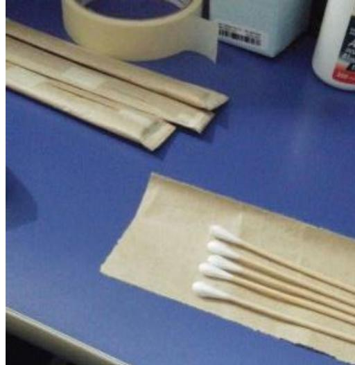
**Figura 1. Preparación de hisopos estériles. Se empaquetó con dos envoltorios de papel kraft y se lo llevó a la máquina de autoclave a esterilizar.**
