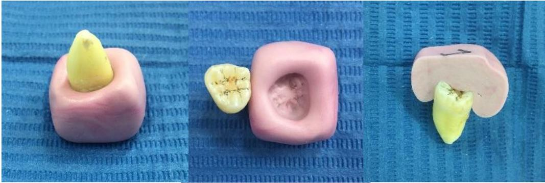
**Fig. 1** Impresión coronal con zetalabor, utilizada como matriz de desgaste.
