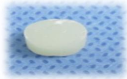
Figura 10: Se retira la resina dental del molde de acero inoxidable.
