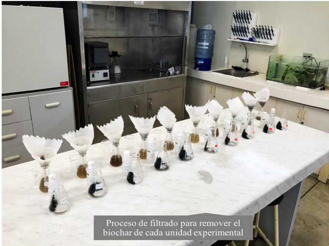
Proceso de filtrado para remover el biochar de cada unidad experimental
