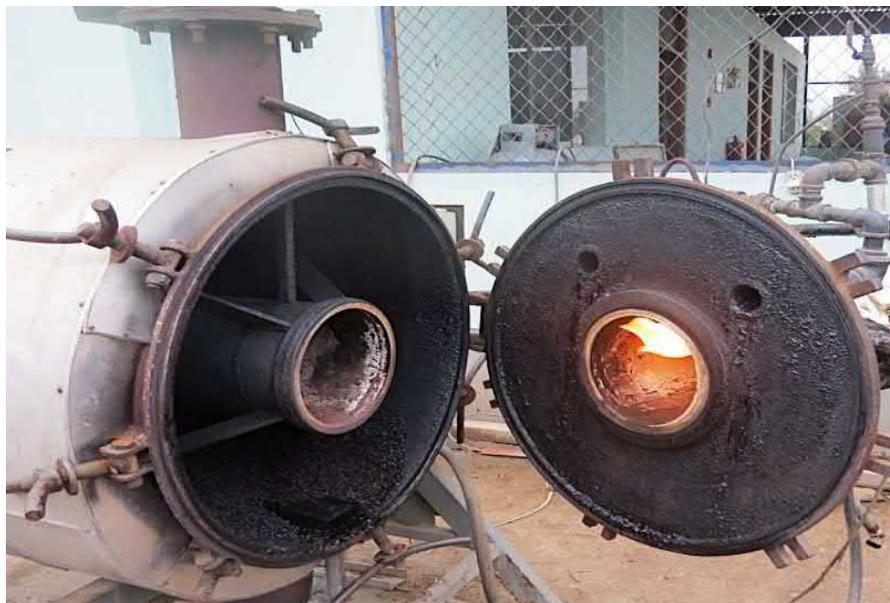
Figura 9. Gasificador en donde se llevó a cabo las reacciones de pirolisis para la obtención de biochar. Archivo personal.
