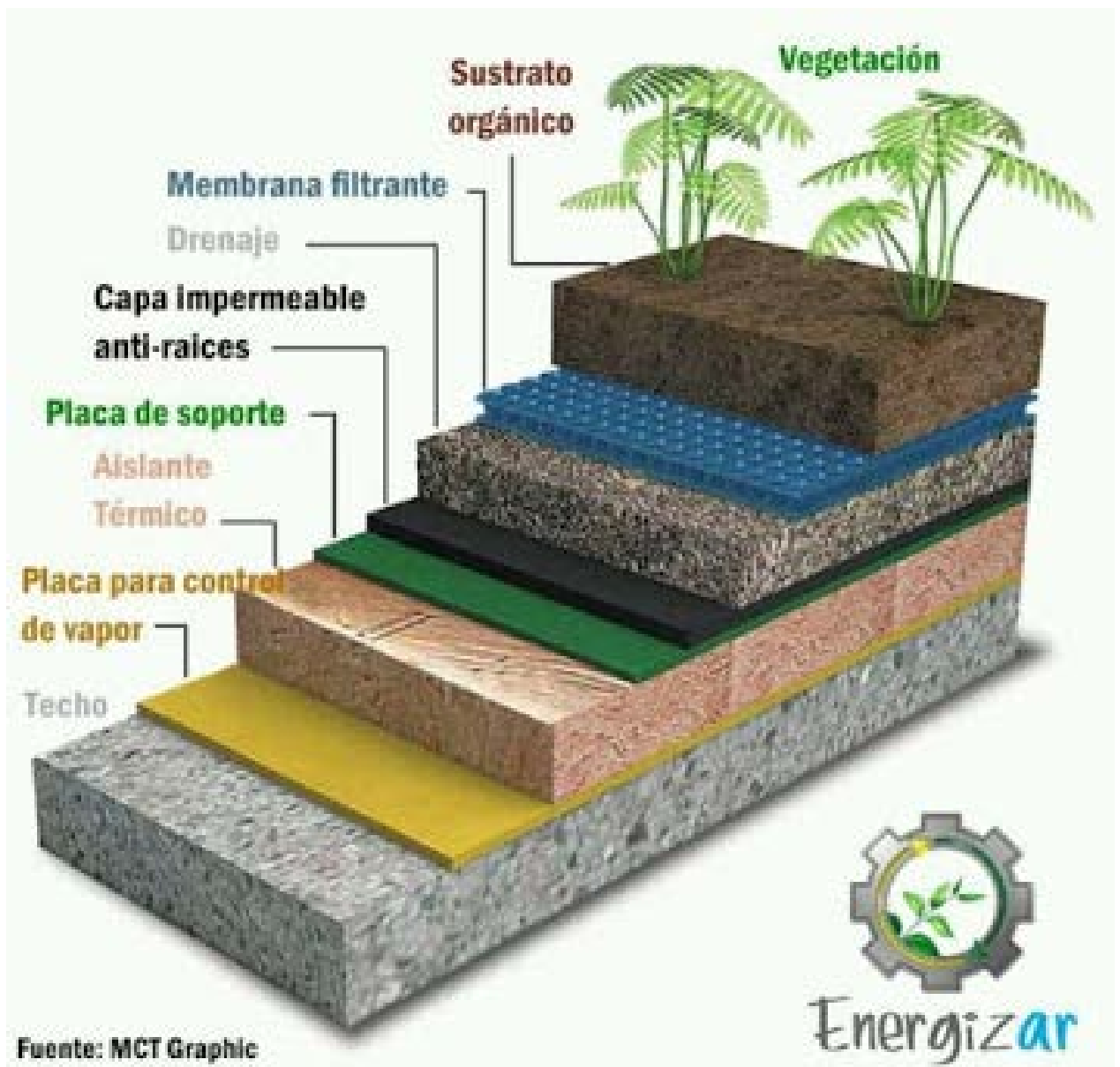
Ilustración 63. Sistema de capas del techo verde
