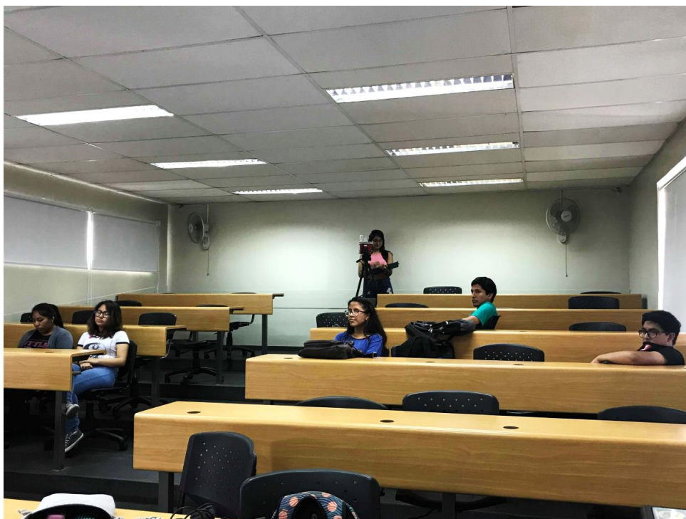
Figura 54: Monitoreo de confort térmico en el aula. Se realizaron 3 mediciones a diferente nivel dentro del salón: bajo, medio y alto
