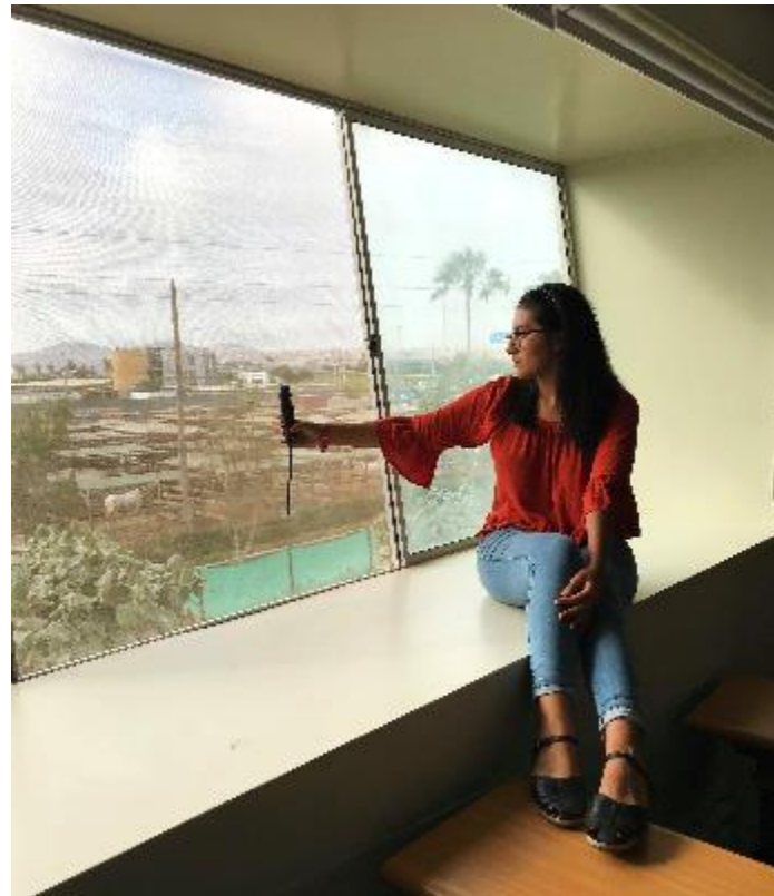
Figura 53: Monitoreo de velocidad del viento en cada una de las entradas del aula.
