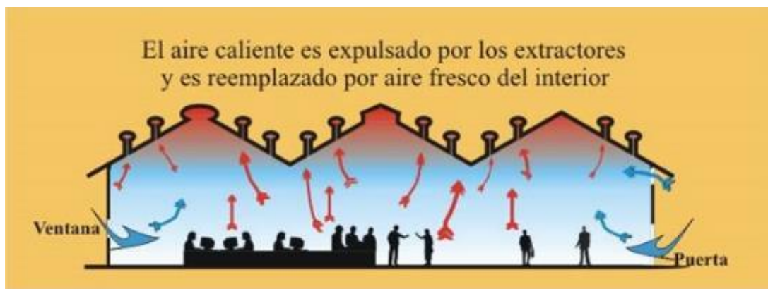
Figura 4: Extractores eólicos y su función principal.
